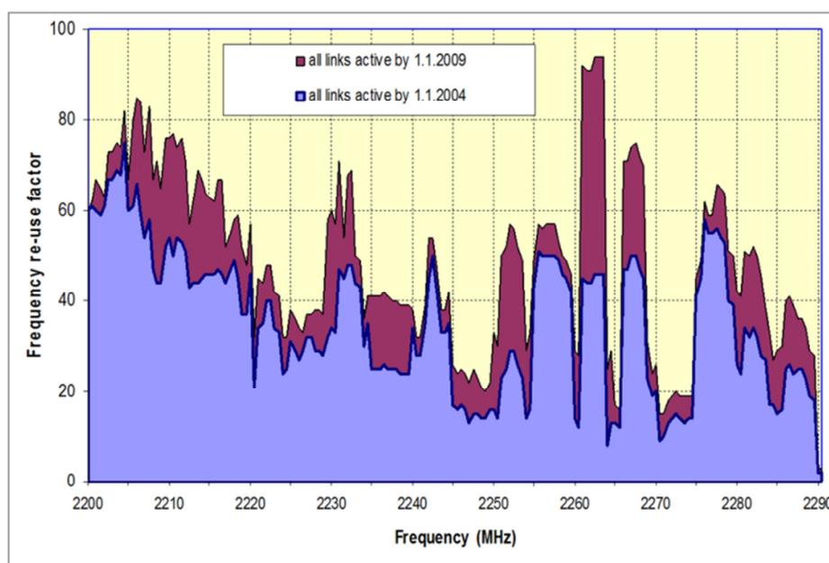
**Figure 8 – Utilisation of S-band TT&C**
